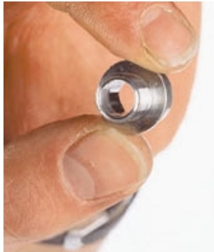
ACHTUNG: Die dämpferseitige Schraube ist eine Alu-Hohlschraube sehr dünner Wandstärke und verträgt kein so hohes Anzugsmoment, wie es der benötigte 8-mm-Inbusschlüssel vermuten lässt. Gönnen Sie jedem Tauchrohr schließlich noch zwei Stöße aus der Fettpresse.
